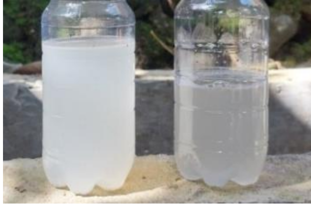
Gambar 3. Air limbah sebelum dan sesudah filtrasi
