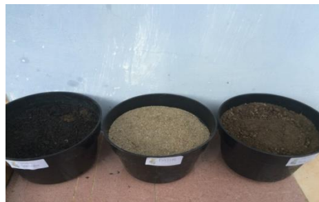
Gambar 2. Wadah Tanah Tempat Uji Biodegradabel
